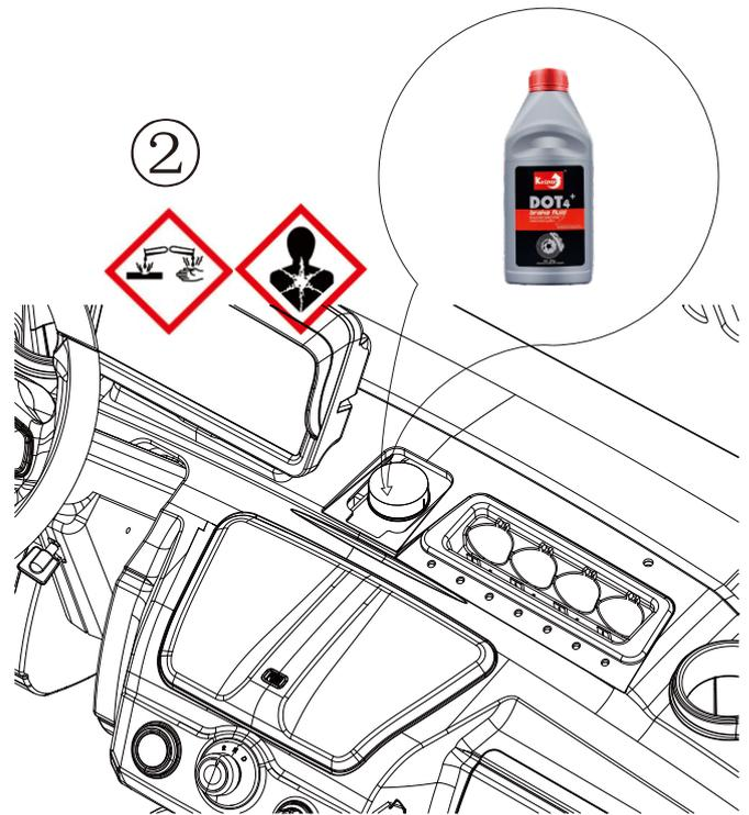
2.CHECK THE FLUID LEVEL ,ADD DOT 4 BRAKE FLUID TO THE TANK .
