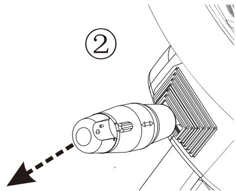
2. PULL DOWN THE CONTROL STALK TO ENABLE THE HIGH BEAM (AFTER LOW BEAM IS ENABLED)
